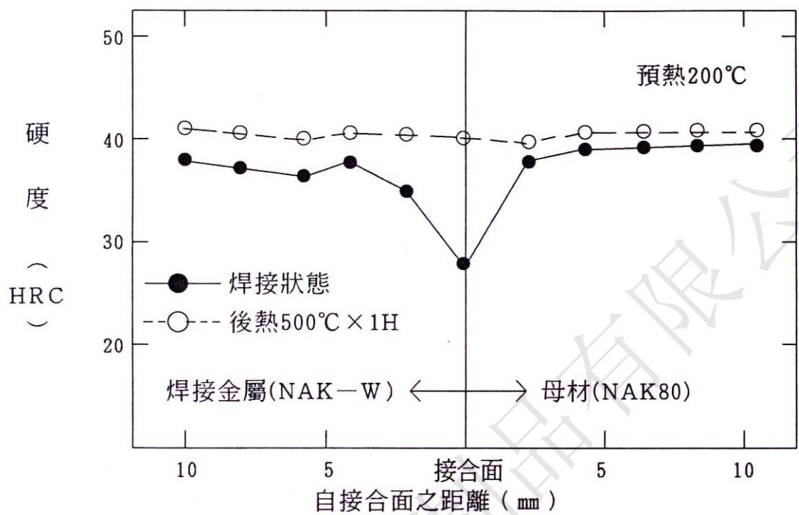
圖 10 NAK80 修補焊接部之硬度
