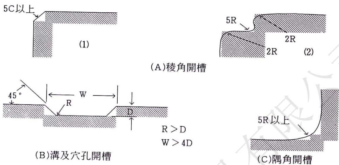
圖 14 開槽加工尺寸例
