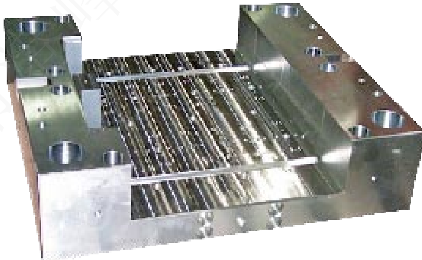
RoyAlloy制作的模具(152×711×813mm)在大机械加工量去除的前提下仍然能够保持尺寸稳定,对角线变形量仅0.15mm。
